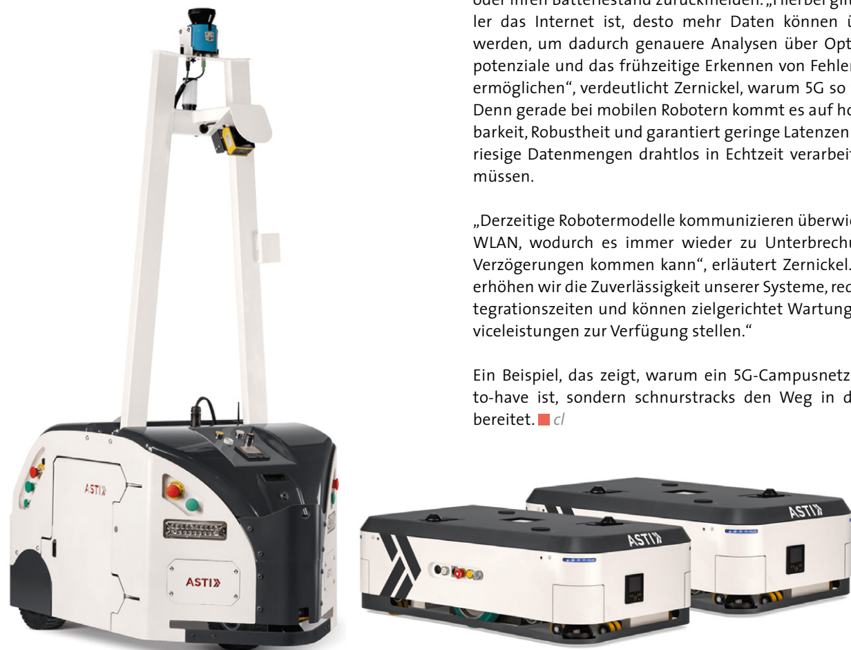
Fahrerlose Transportfahrzeuge (FTF) von ASTI Mobile, die verschiedenste Lasten autonom transportieren können
