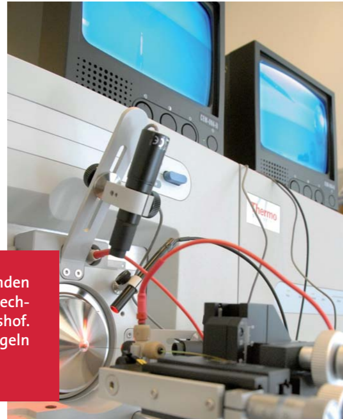
↑ Massenspektrometer zur Identifizierung der gefischten Proteine
