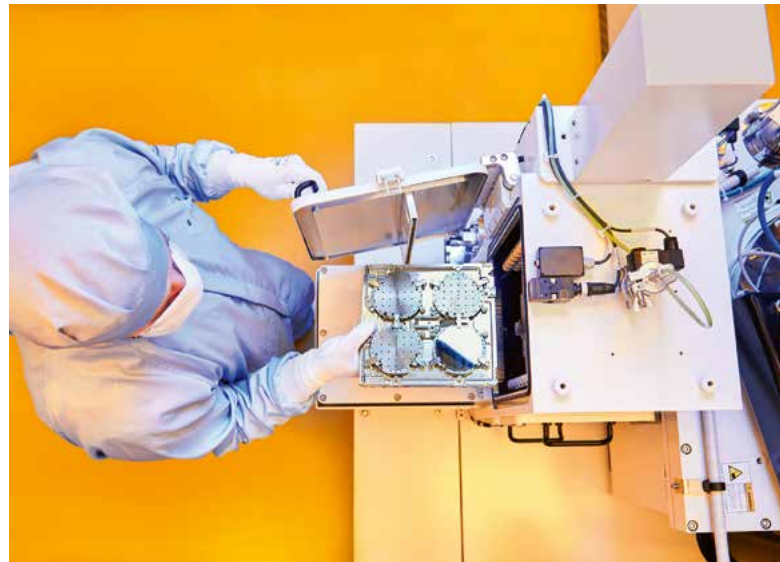
Reinraum, Elektronenstrahlolithografie: Strukturierung von Halbleiterschichten zur Herstellung mikroelektronischer Bauelemente
