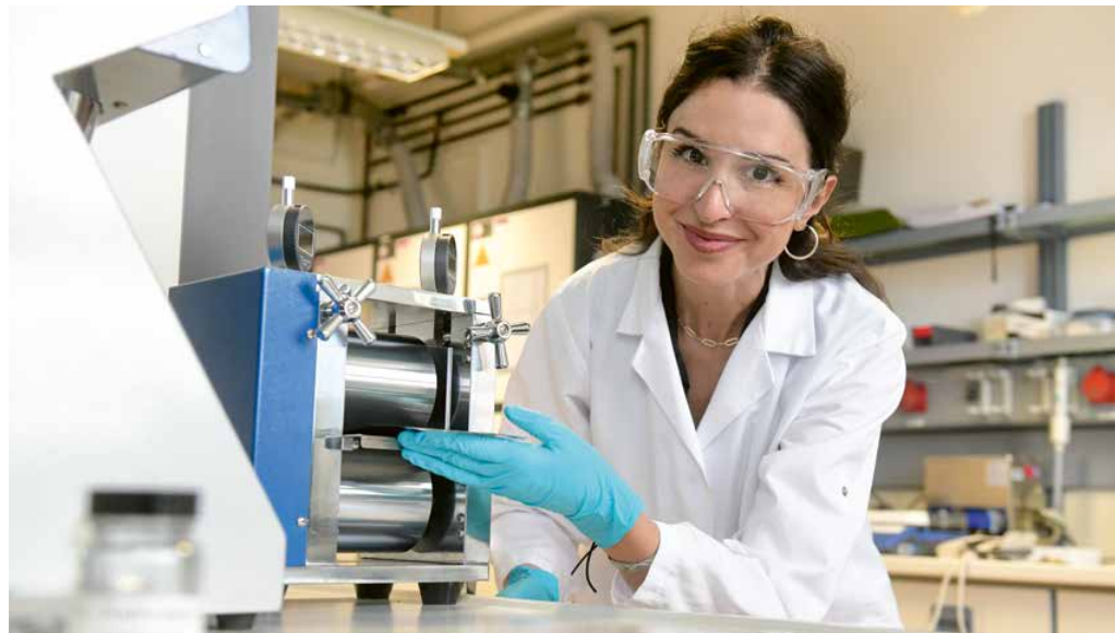
Dalia Morcillo zeigt auf eine manuelle Walzenpresse, die die Durchlässigkeit des Kathodenfilms verringert und eine gleichmäßige Dicke erzeugt
