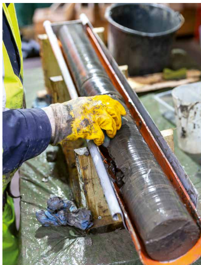
Wie sieht es in der Tiefe aus? Die vom GeoForschungsZentrum Potsdam geborgenen Bohrkern liefern Antworten
