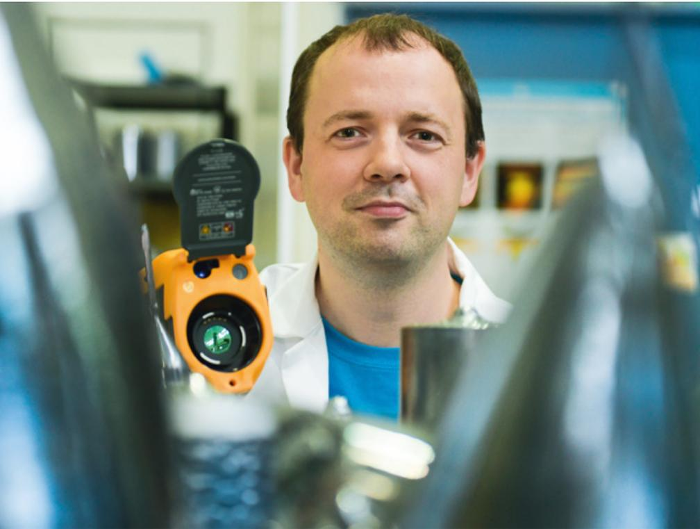
Kaspars Dadzis hält eine Wärmebildkamera, mit der die Temperaturverteilung in einem Kristallzüchtungsprozess visualisiert bzw. beobachtet werden kann.
