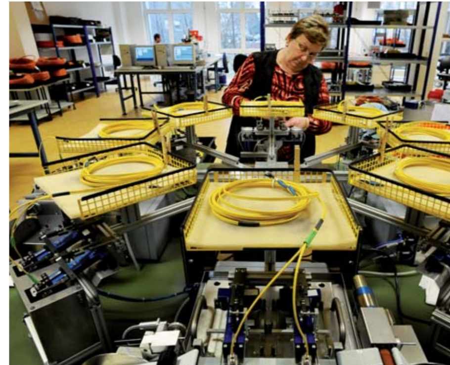
↑ Saubere Sache: Am Polierautomat werden alle 30 Sekunden zwei Glasfaserstecker bearbeitet
