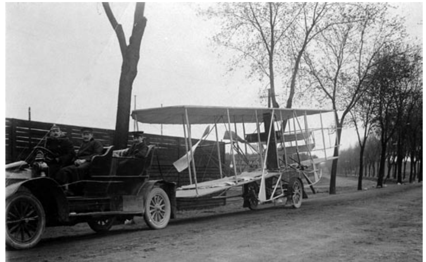
Flugzeugtransport (Wright-Flyer) von der Fertigung zum Einfliegen, hier auf der Rudower Chaussee.
