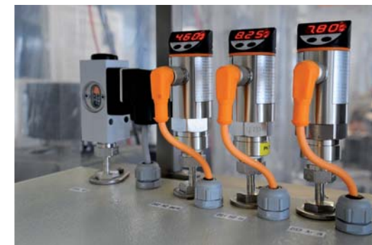
// Messsysteme zur Einstellung exakter Wasserstoffflussraten
